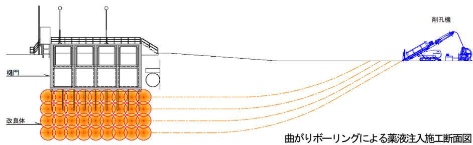
曲がりボーリングによる薬液注入施工断面図
