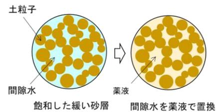
浸透固化工法適用例（浸透固化処理工法技術マニュアル 2010年版より）
